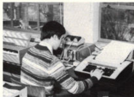
Afb. 4. Met behulp van een microcomputer-ontwikkelingssysteem (het programmeerstation) wordt de op een klavier gespeelde muziek vastgelegd.
