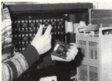
Afb. 3. De „liedjes-chip" wordt in het carillonstation geplaatst en via solid-state relais worden de elektromagnetische hamers van het carillon aangestuurd. Met het toetsenbord (geheel rechts) kan het speelschema worden gekozen.
